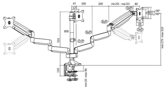
TFT- / LCD-Monitorarm, aus Aluminium, 3-fach - Abmessungen
